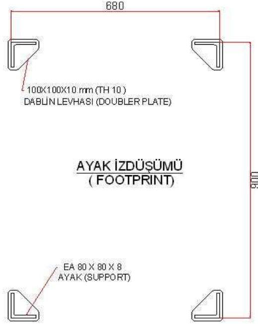
Şekil 2.4: Tank ayak izdüşüm detayı
