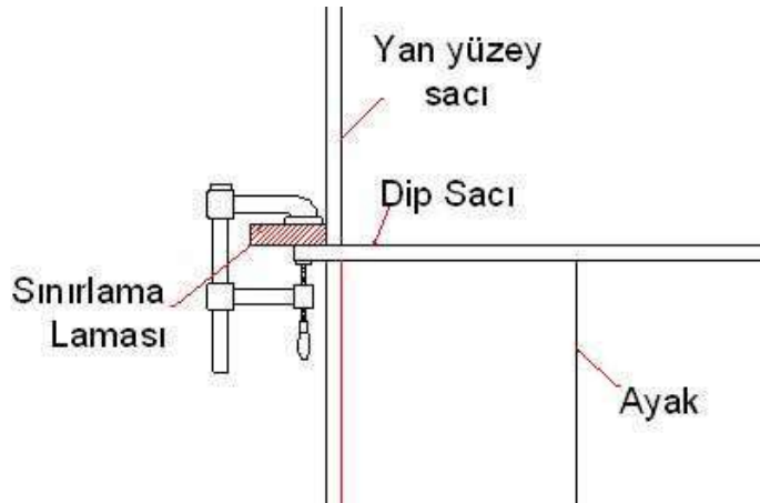
Şekil 2.2: Dip sacı kenarına işkence ile sınırlayıcı sabitlenmesi
