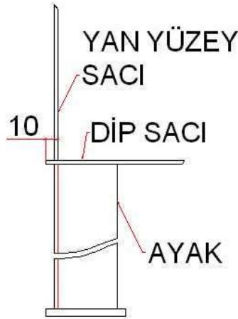
Şekil 2.1: Dip sacı kenarından içeride kalan yüzey sacı
