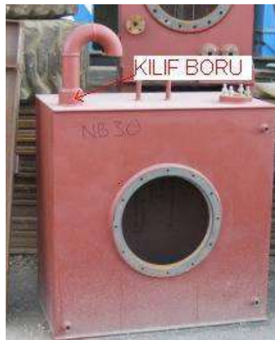
Resim 1.4: Kılıf boru uygulaması
