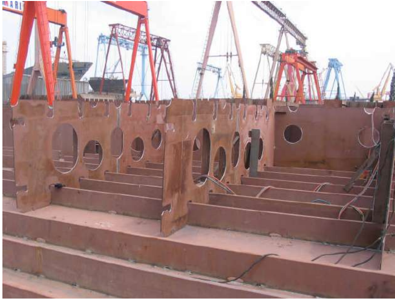
Resim 1.3: Tulaniler ve dolu döşeklerin panel üzerinde kaynatılışı
