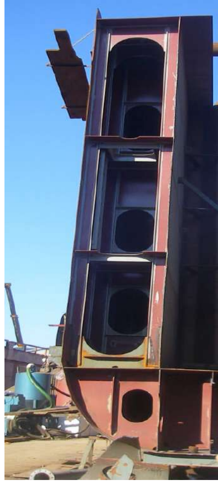
Resim 2.2: Ambar yan bloğunu innerbottom sacına kaynak edilmesi
