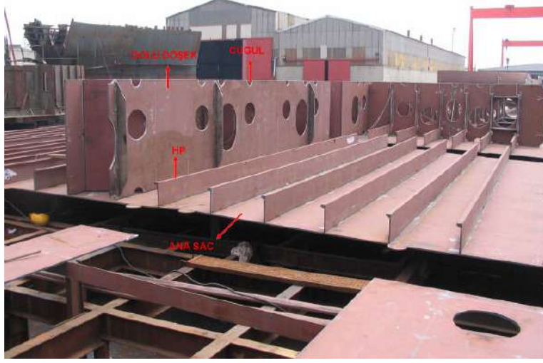
Resim 1.2: Double bottom bloğunun jig üzerine yerleştirilişi. Ana dip sac, döşek ve tulaniler kaynatılmış
