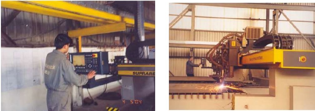
Resim 1.3: Verilen resimlere göre sacın kesime hazırlanması ve kesilmesi
