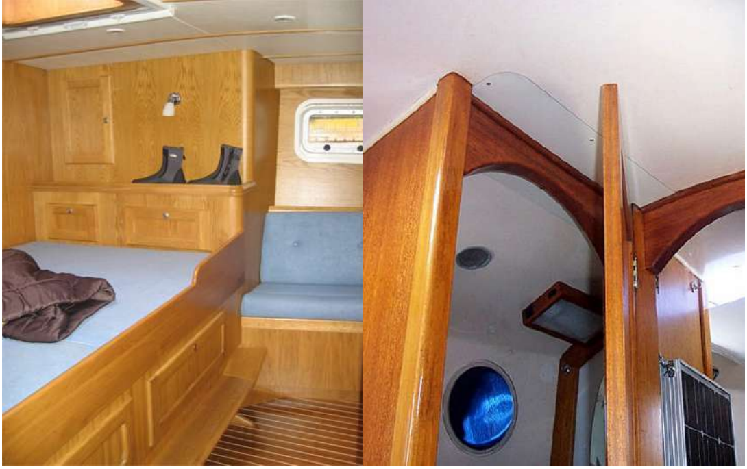
Resim 2.3: Kemere altına yapılmış üst kaplama-Resim 2.4: Kemere altına yapılmış üst kaplama
