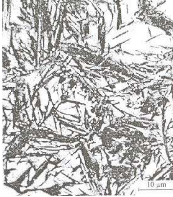
Şekil 1.8: Çeliklerde su verme sonucunda oluşan martenzitik yapı
