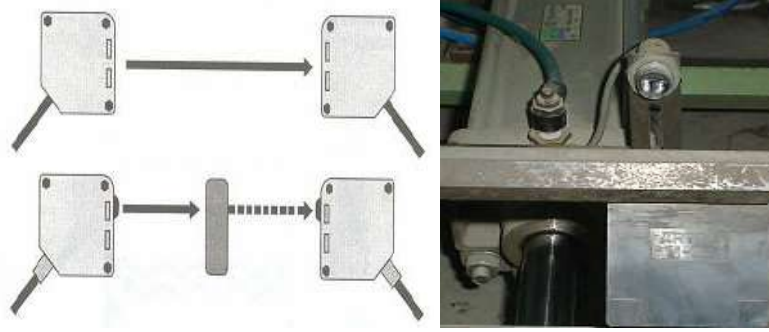
Şekil 3.10: Sensörün çalışma mantığı
