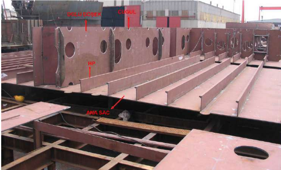
Resim1.2: Double Bottom bloğu jig üzerinde kurulmaya başlandı. Ana dip sac, döşek ve tülâniler kaynatılmış.
