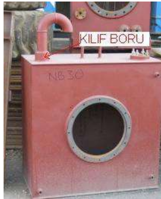
Resim 2.4: Kılıf boru uygulaması
