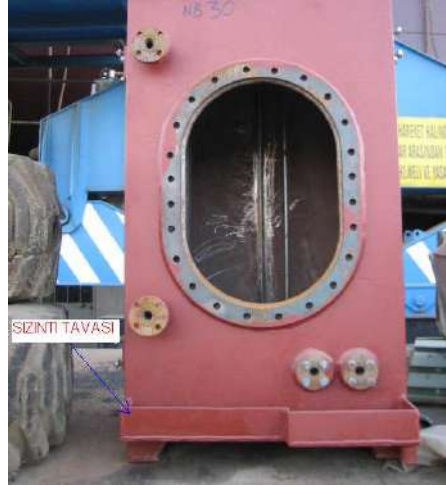
Resim 2.3: Tank üzerine monte edilmiş sızıntı tavası
