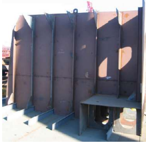
Resim 1.10: Perde stifner, braket ve tülani bağlantısı
