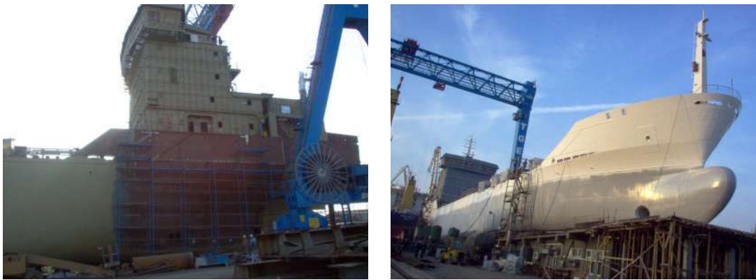
Resim 2.1: Gemi astar boyasının yapılışı
