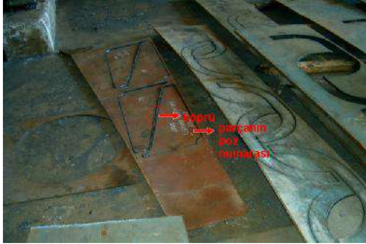
Resim 1.4: Kesilen parçalar ve aralarındaki köprü
