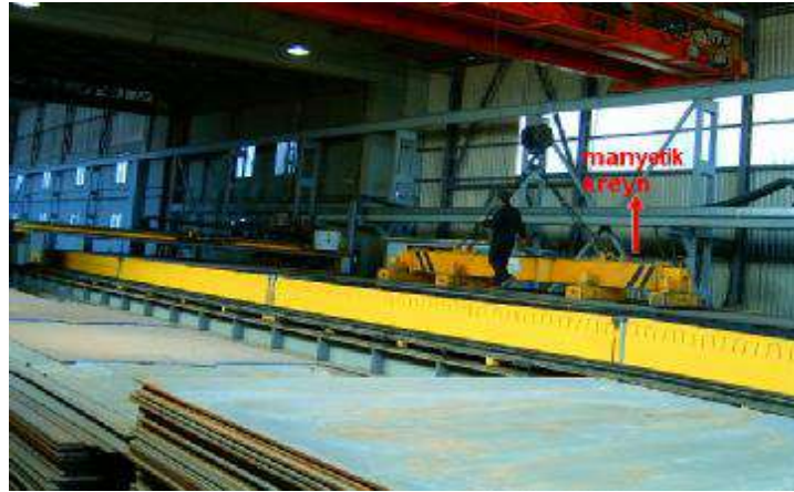
Resim 1.2: Manyetik kreyin ile sac plaka taşınırken
