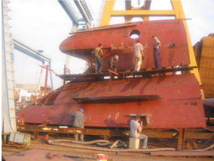
Resim 1.8: Ters olarak inşa edilen blok
