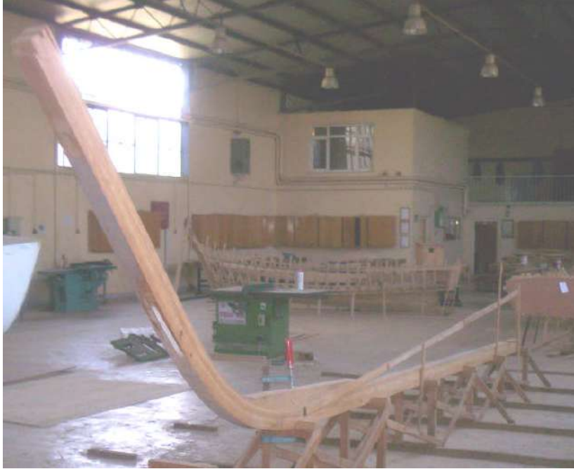
Resim 3.2: Laminasyon tekniği ile üretilmiş yekpare omurga ve baş bodoslama
