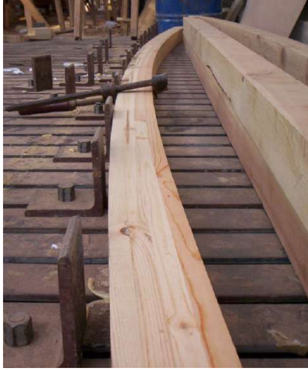
Resim 3.3: Ahşap malzemelerin laminasyonunda kullanılan kalıp
