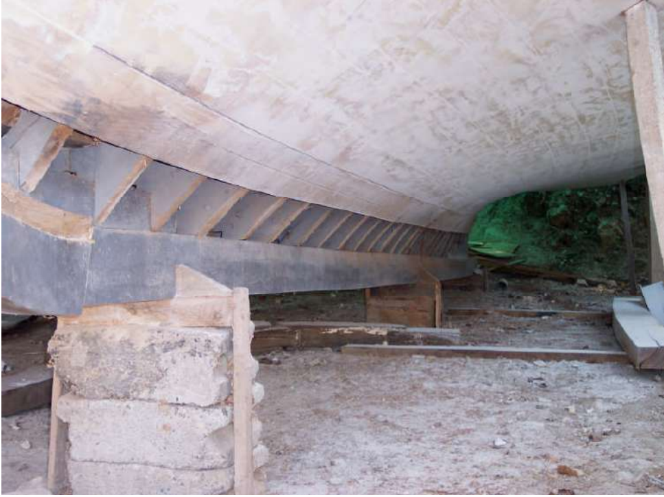
Resim 1.4: Beton malzeme kullanılarak yapılmış bir tezgah hattı (tezgâh hattı kurulurken omurganın baş ve kış tarafındaki açısall fark net bir şekilde görölmekte)
