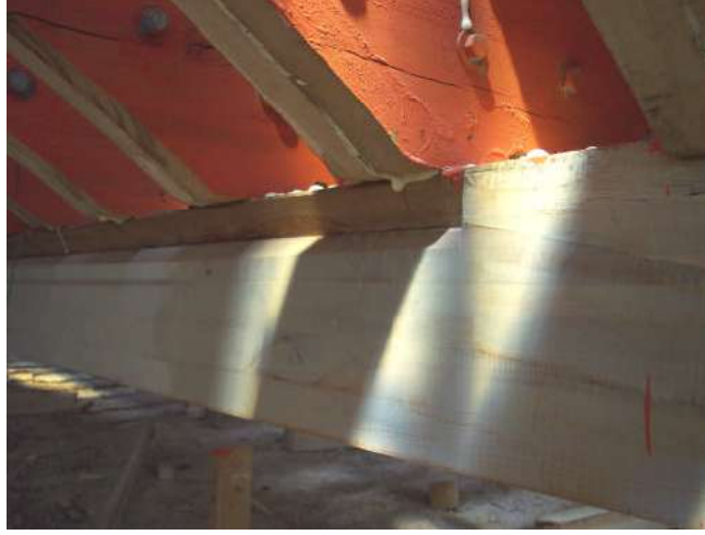
Resim2.18:Omurga üzerindeki aşoz kanalı
