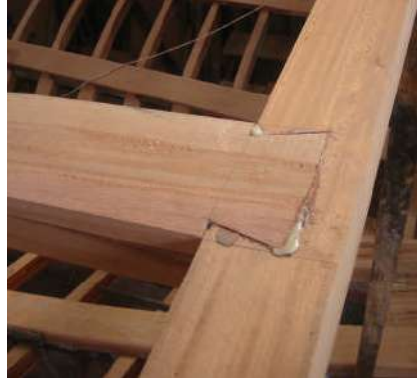
Resim 1.4: Ahşap kemerelerin atkılara kırlangıç kuyruğu bağlanması
