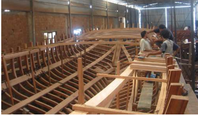
Resim 1.8: Öksüz kemerelerin bağlanması
