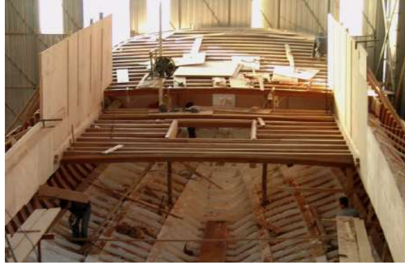
Resim 1.5: Alt güverteler ve kemereleri
