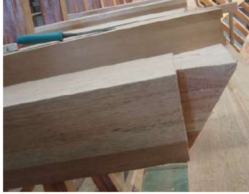
Resim 1.3: Ahşap kemerelerin boyutlandırılması ve kırlangıç kuyruğu açılması
