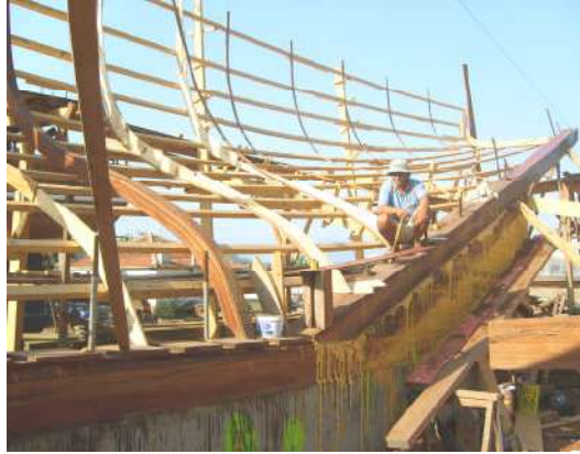
Resim 1.5: Ahşap döşeklerin aralarının takozlarla desteklenmesi
