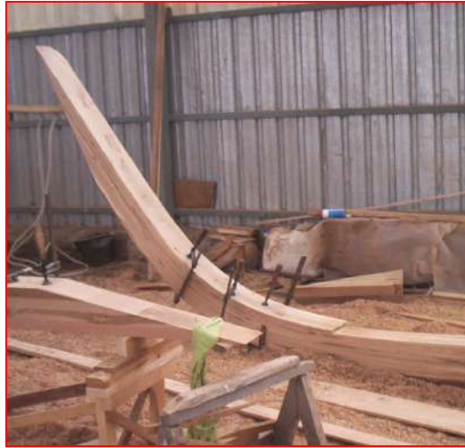
Resim 2.2: Lamine bodoslamaya form verilmiş
