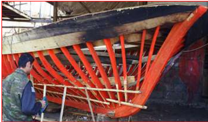
Resim 1.2: Masif baş bodoslamalı bir tekne iskeleti
