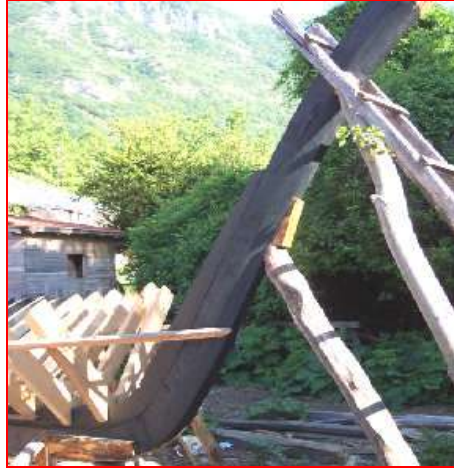
Resim 1.4: Bodoslama ve döşekler
