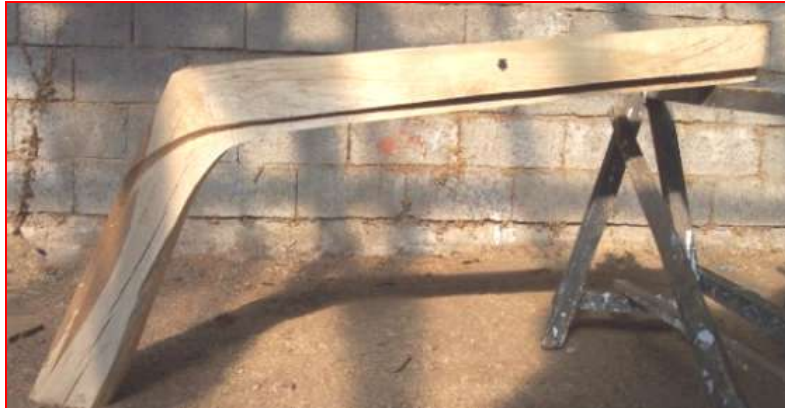
Resim 1.9: Ayna kıç için hazırlanmış tek parça masif kıç bodoslama
