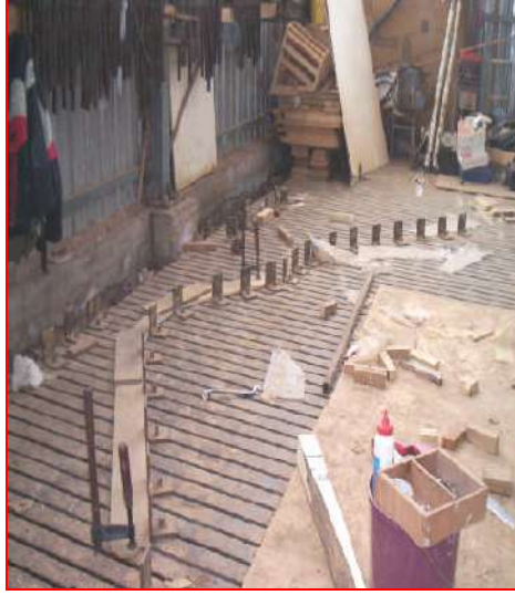
Resim 2.3: Lamine bodoslamaya formun verildiği kalıplar
