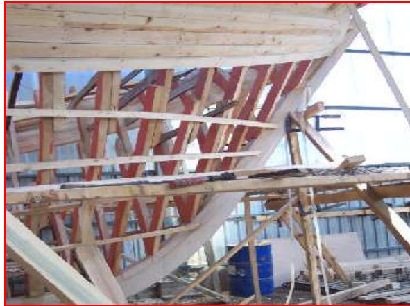
Resim 1.5: Baş bodoslamaya aşoz oluğu açılmış, akrep kullanılarak omurgayla birleştirilmiş, borda kaplanmaya başlamış
