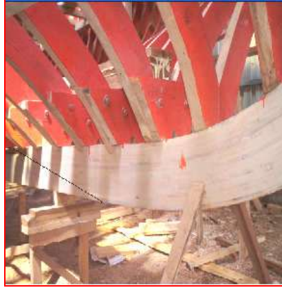
Resim 1.6: Omurga, baş bodoslama, döşekler ve postalar
