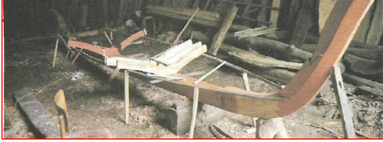
Resim 1.3: Omurga, bodoslama ve döşekler
