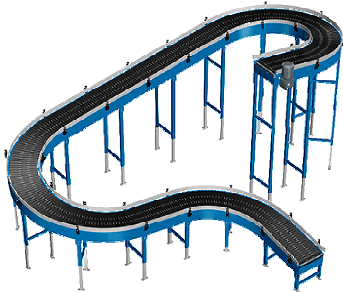
Şekil 6.10 Doğrusal olmayan paletli konveyörler
