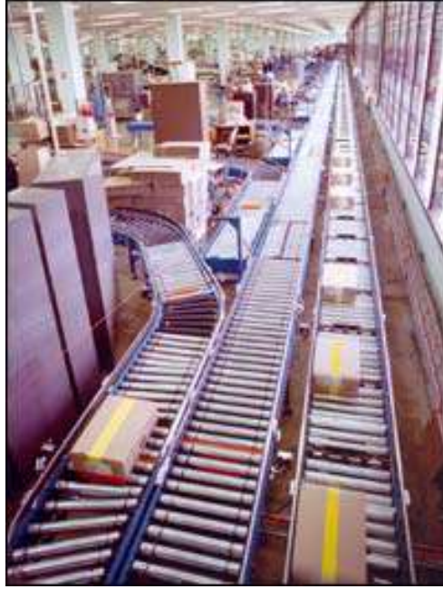
Şekil 2.14 Avara masuralı (rulolu) transport sistemleri
