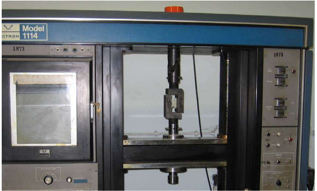
Şekil 4.1.1.1 Aparatın bağlanması ve çekme test cihazının genel görünüşü
