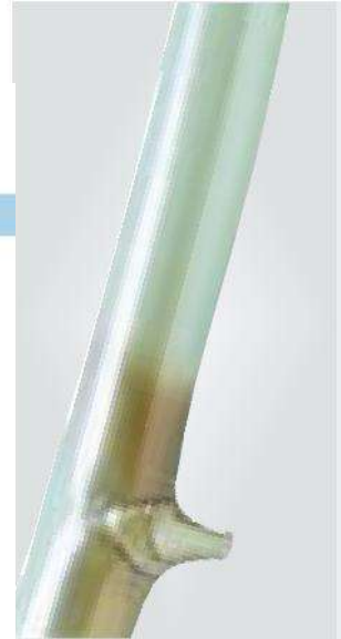
Hortum aşırı basınç ve aşırı ısıdan ötürü patlamış
